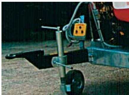
Fig. 10 - Piede di appoggio per evitare il ribaltamento accidentale.
