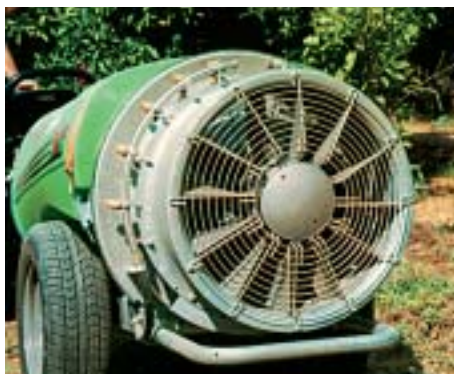
Fig. 18 - Griglia metallica per evitare il contatto accidentale con le pale del ventilatore.
