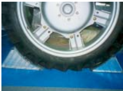
Fig. 11 - Cunei di bloccaggio per le ruote per evitare lo spostamento accidentale.
