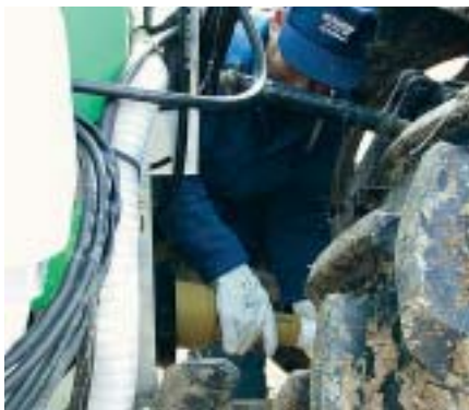
Fig. 7 - Collegamento dell'albero cardanico alla trattrice.
