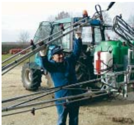
Fig. 16 - Apertura/chiusura manuale delle barre.
