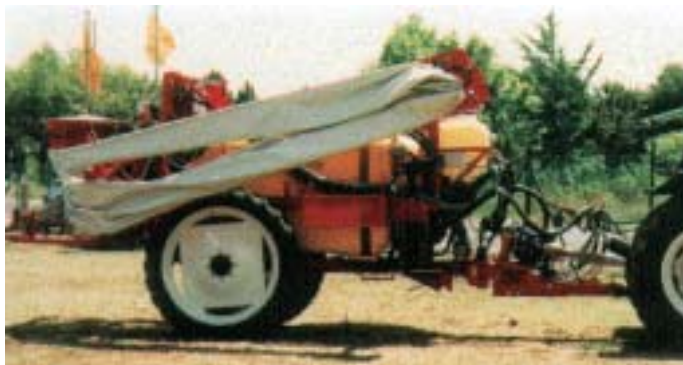
Fig. 21 - Irroratrice di tipo trainato, con elementi ribaltabili in posizione di trasporto.
