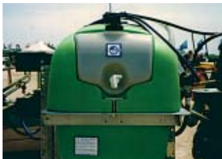
Fig. 15 - Le irroratrici devono essere dotate di un serbatoio per acqua pulita ad uso dell'operatore che abbia una capacità minima di 15 l.
