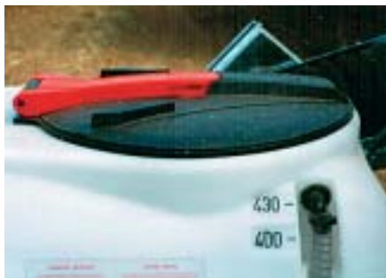
Fig. 19 - I coperchi devono essere: solidali al serbatoio; dotati di un sistema per il mantenimento in posizione chiusa ad azione meccanica positiva (ad es. coperchi a vite); a tenuta stagna nei confronti della miscela di irrorazione.
