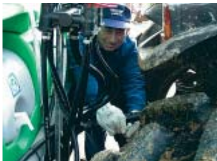
Fig. 6 - Regolazione dell'attacco a tre punti per evitare oscillazioni della macchina durante il trasporto e il lavoro.
