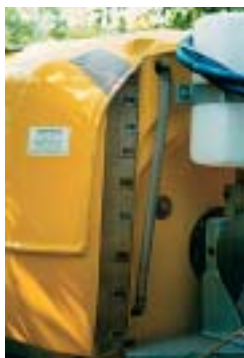
Fig. 14 - Il livello del liquido all'interno del serbatoio deve essere visibile da parte dell'operatore durante le fasi di riempimento e di svuotamento.
