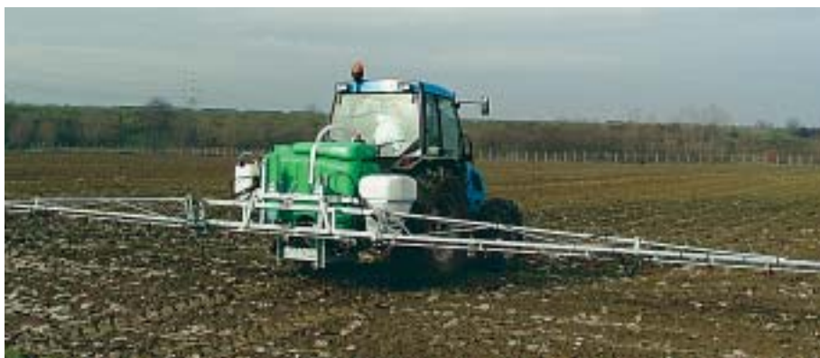
Fig. 17 - Irroratrice in posizione di lavoro.
