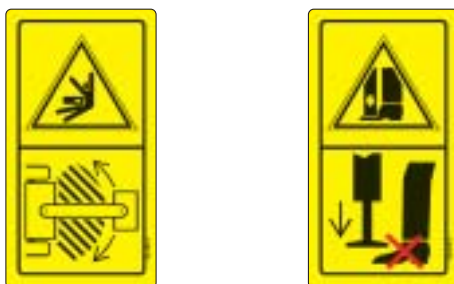
Fig. 6 - Esempio di pittogrammi richiamanti l'attenzione sui rischi connessi all'accoppiamento della macchina al trattore.
