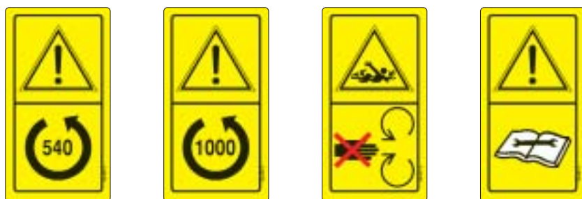
Fig. 9 - Esempi di pittogrammi che indicano pericoli connessi al montaggio e all'impiego dell'albero cardanico.
