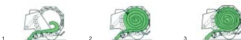
Fig. 4 - Schema di funzionamento di una rotoimbattrice a camera di compressione con volume costante in grado di realizzare balle a cuore morbido.
