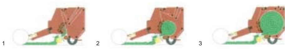
Fig. 3 - Schema di funzionamento di una rotoimbattrice a camera di compressione con volume variabile in grado di realizzare balle a cuore duro.
