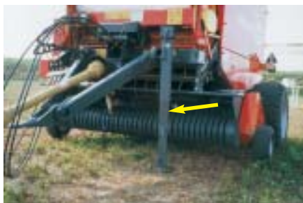
Fig. 10 - Piede di appoggio per evitare il ribaltamento accidentale.
