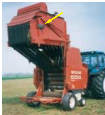
Fig. 11 - Cunei di bloccaggio delle ruote per evitare lo spostamento accidentale.
