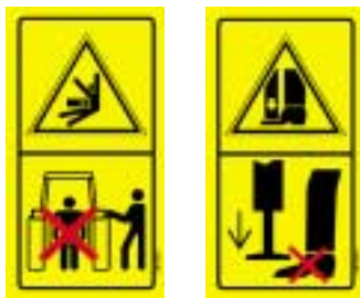
Fig. 12 - Esempio di pittogrammi richiamanti l'attenzione sui rischi connessi all'accoppiamento ed al disaccoppiamento della macchina alla trattrice.
