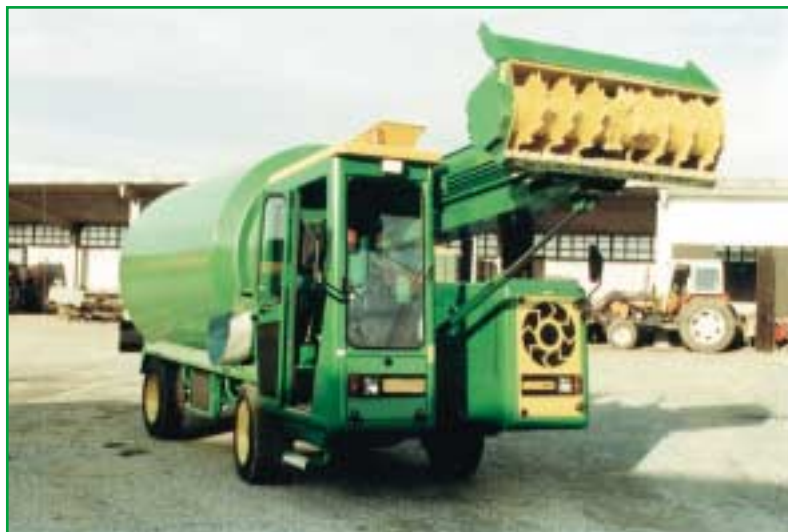
Fig. 5 - Esempio di carro desintegratore-miscelatore semovente con coclea di miscelazione ad asse inclinato.
