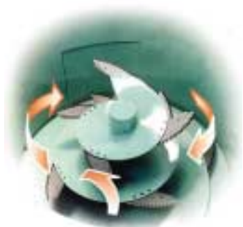
Fig. 7 - Flusso del prodotto su coclea verticale.
