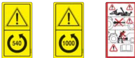
Fig. 4 - Esempi di pittogrammi riferiti alla trasmissione trattore-attrezzo.
