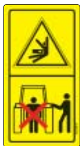
Fig. 17 - Pittogramma indicante il divieto di sostare fra trattore ed attrezzo.
