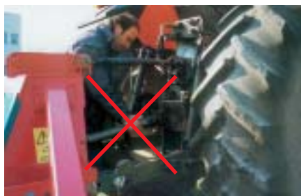
Fig. 6 - L'albero cardanico deve essere dotato di protezioni idonee per tutta la lunghezza dell'albero e dei giunti cardanici sia sull'operatrice che sul trattore.
