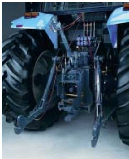
Fig. 2 - Attacco a tre punti di tipo rapido.
