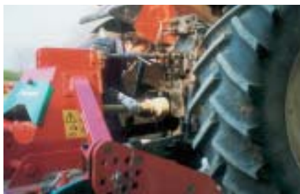
Fig. 5 - Collegamento dell'albero cardanico alla trattore; l'albero cardanico deve essere fissato correttamente alla p.d.p. e al lato macchina rispettando il verso di rotazione e fissando le catenelle per evitare la rotazione delle protezioni.
