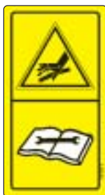
Fig. 19 - Esempio di pittogramma per fluidi in pressione.
